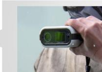
赤外線放射温度計を使用して矯正時(曲げ戻し開始時)の温度を確認
