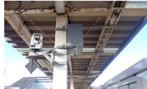
自動軌道計測システム
